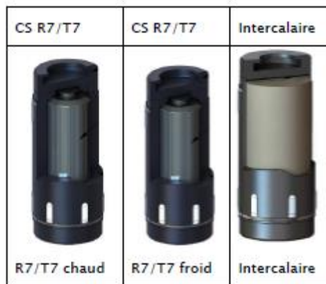
Figure 4 - Illustration des colis de stockage HA fortement exothermiques (HA1, HA2)
