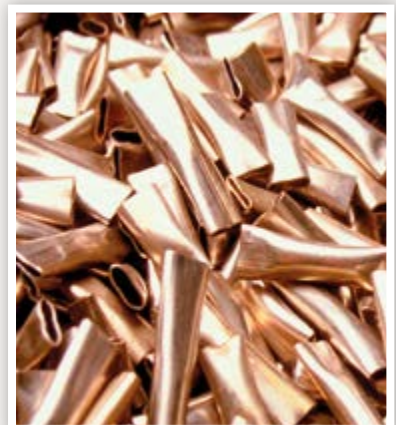
► Pièces métalliques cisaillées radioactives issues du retraitement du combustible usé
