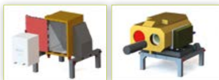
► Hottes de transfert des colis de déchets MA-VL et HA
