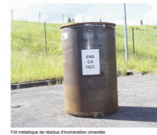
Fût métallique de résidus d'incinération cimentés
