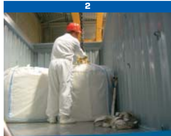
2 • Après contrôle des colis contenant des gravats, l'opérateur accroche les anses du big-bag à la pince fixée sur un pont roulant de 6,6 tonnes.
