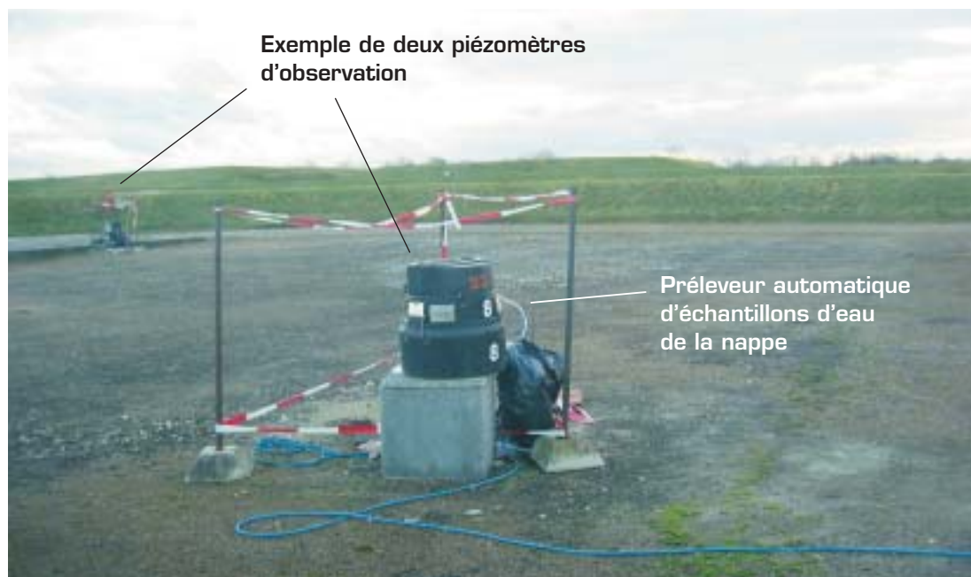
Neufs traceurs ont été injectés dans la nappe. Leur déplacement a été repéré grâce aux piézomètres d'observation.
