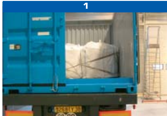
1 • Après contrôle du bordereau de transport au poste de garde, les colis sont acheminés au bâtiment de maintenance pour déchargement. Il s'agit de big-bags de la centrale nucléaire de Saint-Laurent-des-Eaux.
