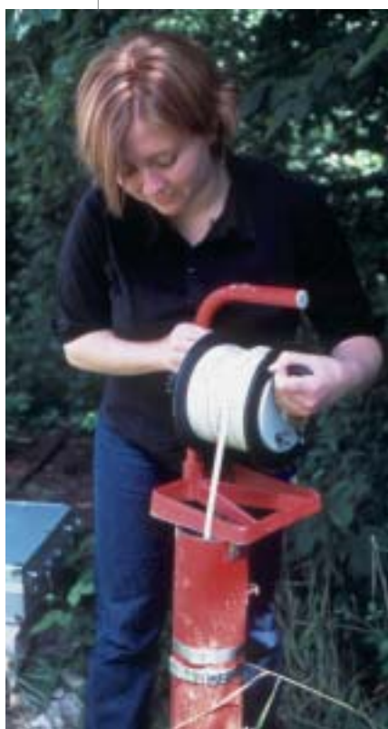
Prise d'échantillon d'eau dans un piézomètre.
