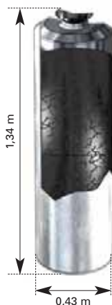
Schéma d'un colis primaire de déchets C vitrifiés R7T7.
