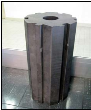
Figure 2 Empilement en graphite
