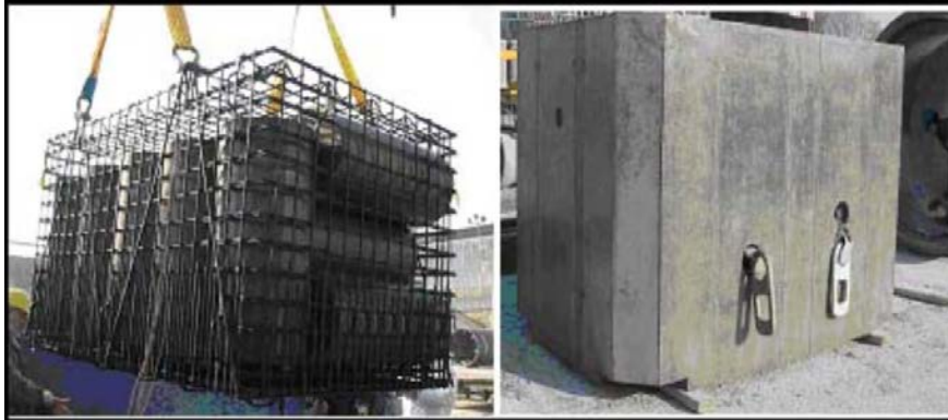
Figure 4 Colis de graphite à l'étude par EDF
