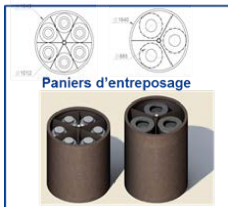
Figure 3 : Solution d'entreposage par empilement de colis HA primaires ou de stockage regroupés en casiers de diamètre identique en puits verticaux fermés et ventilés par thermo-siphonage.
