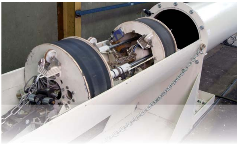
Robot pousseur conçu pour placer les colis de déchets dans les alvéoles de stockage
