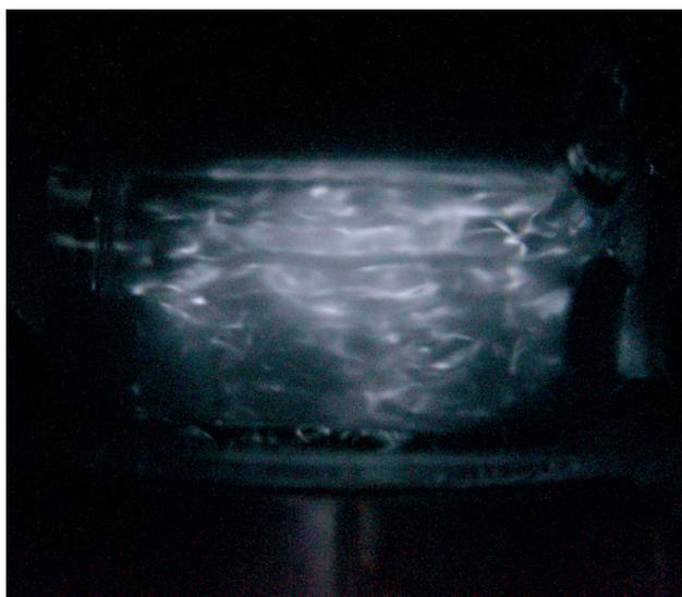
► **Visualisation de la cavitation ultrasonore** : Les ultrasons créent une variation de pression lors de leur passage dans le liquide. Des bulles de gaz se forment et oscillent jusqu'à implosion. Il se crée alors localement un plasma (photo de droite) qui décompose de manière rapide et efficace les agents chimiques utilisés pour la décontamination des installations nucléaires.
