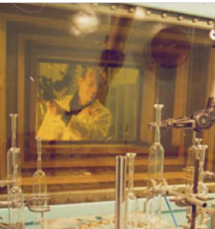
► Fig.2. Installation IRMA (60Co) de l'IRSN permettant de tester le comportement des fibres optiques sous irradiation
