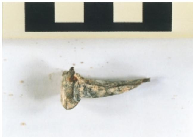
habituellement contenus dans la gangue du minerai, c'est à dire hors du fer métallique : silicium, oxygène, calcium, aluminium, potassium, magnésium, phosphore, soufre, ainsi qu'une quantité notable de chlore. Les variations quantitatives peuvent s'expliquer par la provenance des minerais, probablement différente à plusieurs siècles d'intervalle.
