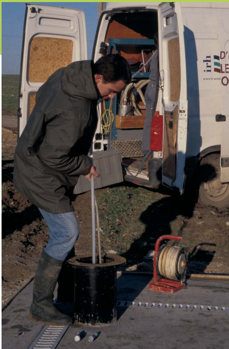
Le suivi de la qualité des eaux souterraines se fait notamment à partir des piézomètres installés autour du Laboratoire
