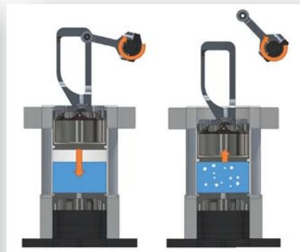
**Principe de cavitation par impact :** Un bras mécanique entraîne un piston et le relâche brutalement, provoquant son impact sur le liquide. Une onde de choc est produite, suivie d'ondes de résonance, qui créent des bulles de cavitation de taille variable.
