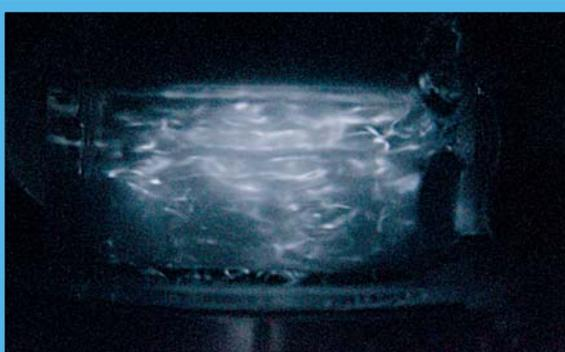
**Visualisation de la cavitation ultrasonore :** Les ultrasons créent une variation de pression lors de leur passage dans le liquide. Des bulles de gaz se forment et oscillent jusqu'à implosion. Il se crée alors localement un plasma (photo de droite) qui décompose de manière rapide et efficace les agents chimiques utilisés pour la décontamination des installations nucléaires.
