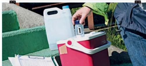
**Pour ne pas altérer leurs propriétés**, les échantillons d'eau sont conservés à une température stable dans des glacières spéciales tout le temps de leur acheminement vers différents laboratoires pour analyses physico-chimiques ou radiologiques.
