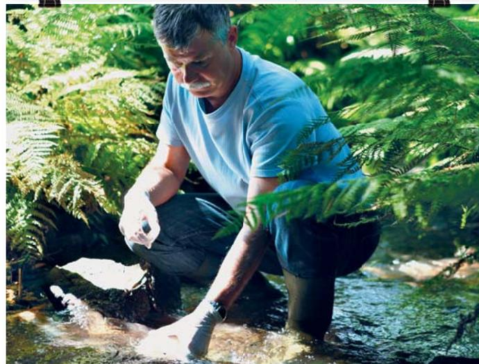
**Prélèvement d'eau** dans le ruisseau de la Sainte-Hélène pour mesurer l'impact radiologique et chimique du centre sur l'environnement.
