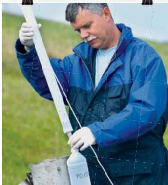
**Prélèvement** dans un des 39 piézomètres du site, qui permettra l'analyse des eaux provenant directement de la nappe phréatique. L'Andra prélève dans 9 autres piézomètres, situés à l'extérieur du site.
