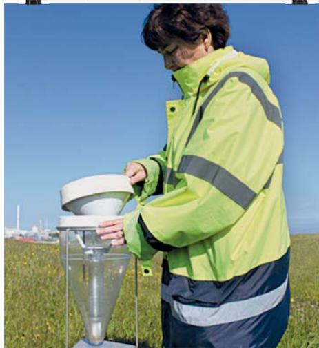
**Mesure** de la pluviométrie pour connaître le volume d'eau tombé sur le centre. En 2016, ce volume a atteint 956 mm. Les eaux de pluie sont canalisées vers les différents systèmes de collecte des réseaux du centre.
