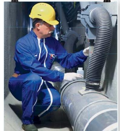
**Prélèvement** dans un des collecteurs de la galerie souterraine, qui permet de mesurer les capacités d'étanchéité de la couverture et des ouvrages de stockage.
