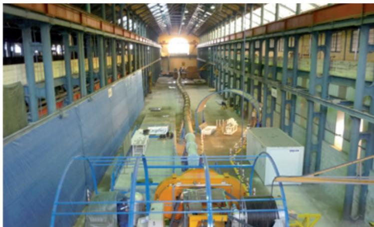
**Figure 16 - Test de retrait d'un colis HA dans un alvéole fortement déformé**
