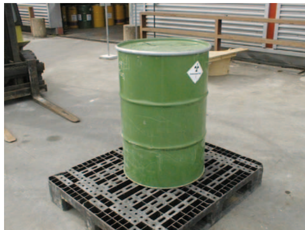
Fût métallique de déchets cimentés
