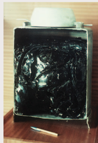
Ecorché (maquette) d'un colis PIVER
