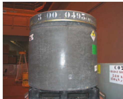
Coques béton de boues et concentrats cimentés
