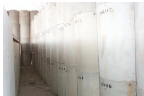
Fûts métalliques temporairement mis en coques en béton pour l'entreposage
