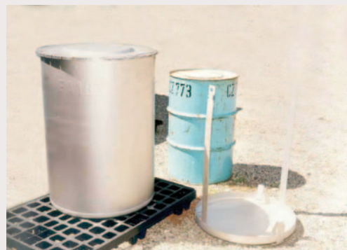
Fût métallique d'enrobé bitumineux et surfût inox EIP
