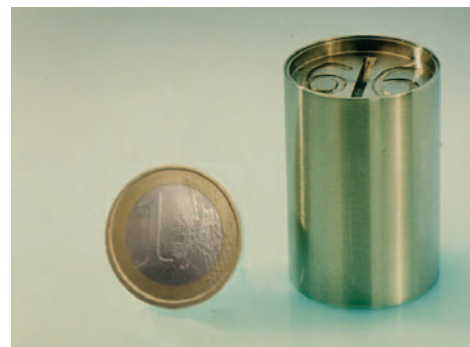
Exemple de source scellée
