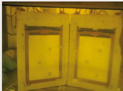
Conteneur en béton-fibres contenant des résines
