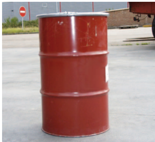
Fût métallique de résines, enrobées dans un polymère
