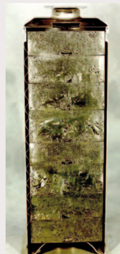
Écorché d'un colis montrant l'empilement de galettes (maquette)
