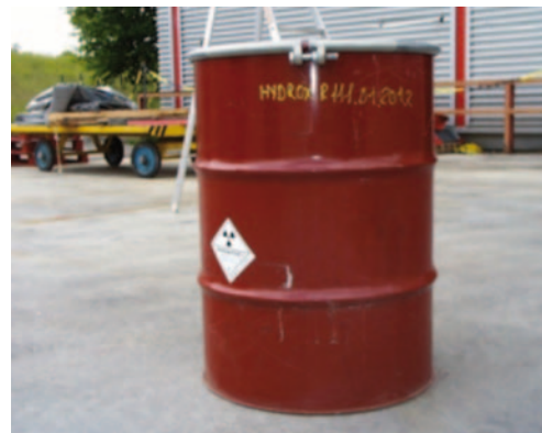
Fût métallique de déchets cimentés
