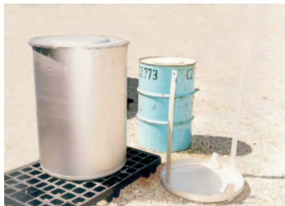
Fût métallique de relargage « soupape » et surfût inox EIP
