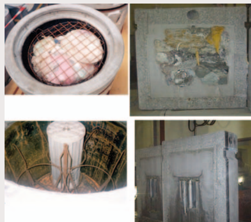
Coques en béton avant injection et coupées (haut : déchets hétérogènes, bas : filtre d'eau) pour expertise
