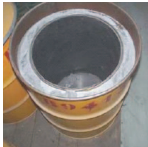
Colis pour sources radioactives scéllées (fût métallique prébétonné)
