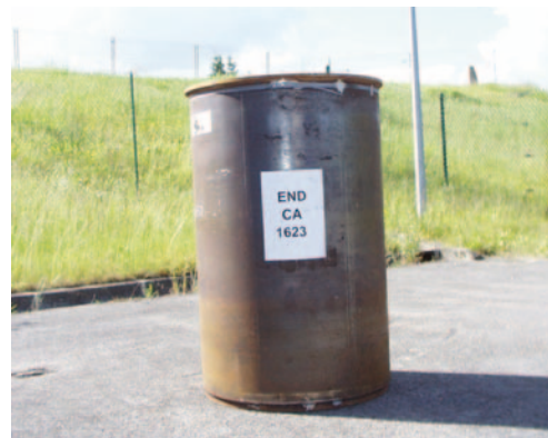
Fût métallique de résidus d'incinération cimentés
