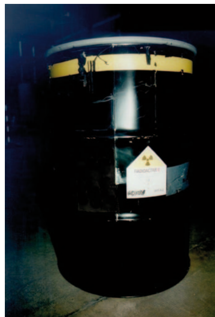
Fût métallique de déchets compactés et cimentés
