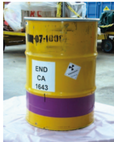
Fût métallique de boues et concentrats cimentés
