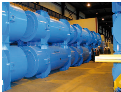
Entreposage des protections neutroniques
