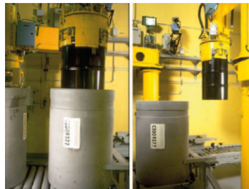
Fût métallique dans un conteneur en béton-fibres (atelier AD2, La Hague)
