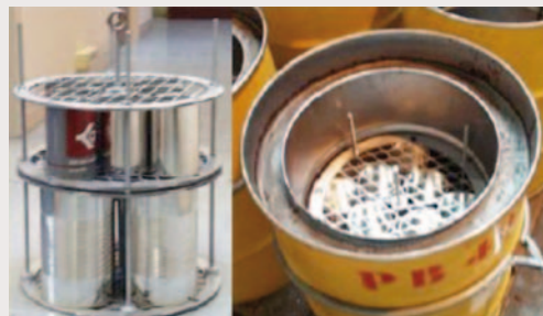
Fût métallique prébétonné équipé d'un dispositif de répartition des boîtes métalliques contenant les sources
