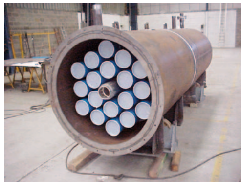
Colis contenant des protections neutroniques
