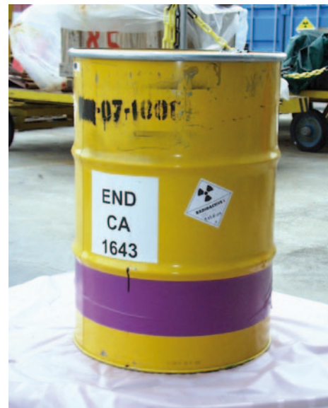
Fût métallique de boues et concentrats cimentés
