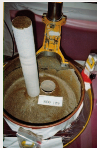
Extraction d'une carotte de résines, pour contrôle
