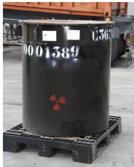
Fût métallique de concentrats cimentés
