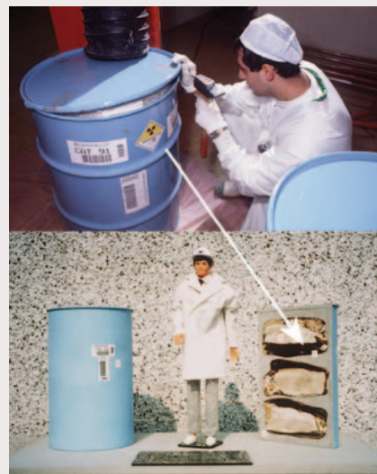
Écorché (maquette) d'un colis presse montrant les fûts primaires compactés sous forme de galettes
