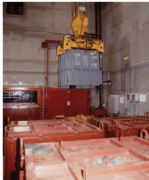
Caisson métallique de 5 m 3
