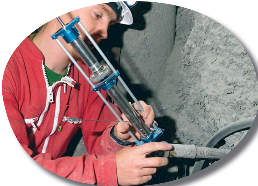
Mesure des variations du diamètre d'une galerie du Laboratoire souterrain
