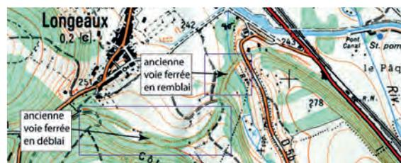
Figure 12 - Carte de localisation de la tranchée ferroviaire de Longeaux (Meuse) – les rectangles entourent les portions de voie ferrée dont les traces vont perdurer
