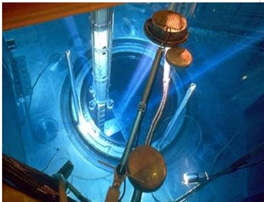
Illustration 13 : manutention d'un assemblage combustible dans un réacteur nucléaire
