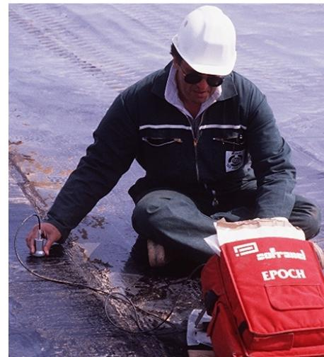
Illustration 83 : contrôle par ultrason de la qualité de la soudure de la membrane bitumineuse en 1995
