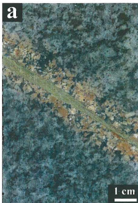
Tonalite altérée séchée à 80 °C pendant 31 jours et saturé pendant 30 jours. La seule zone poreuse correspond à la fissure
