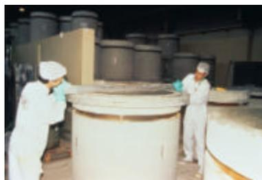
13 - Conditionnement en coque de béton (opération de finition du bouchon d'une coque), EDF
