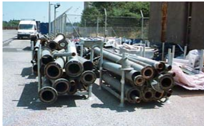
2 - Déchets métalliques TFA
