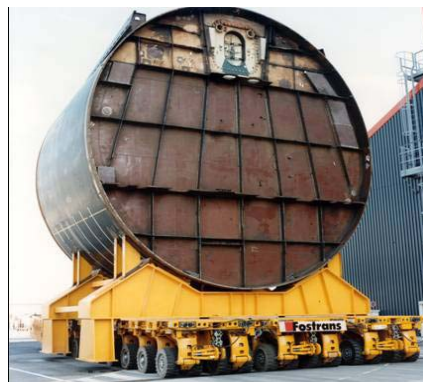
G - Le Redoutable : Découpe de la tranche du réacteur DCN / BIAUGAUD
