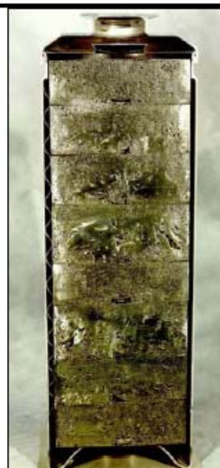
Ecorché (maquette) d'un colis montrant l'empilement de galettes
