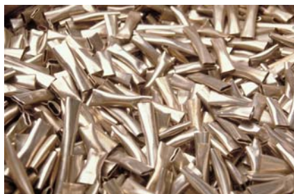
E - Coques et embouts (après cisailage). COGEMA-La Hague COGEMA / P. Lesage
