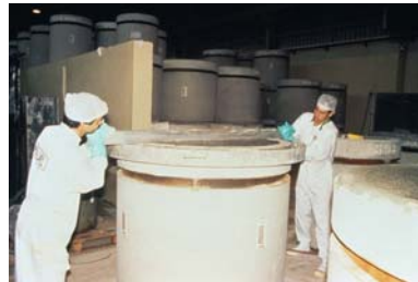
13 - Conditionnement en coque de béton (opération de finition du bouchon d'une coque), EDF
