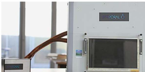
Le concept du projet Temporal est de développer une caméra qui permettra de mieux détecter la radioactivité en captant les rayons gamma issus de la désintégration d'atomes radioactifs.
