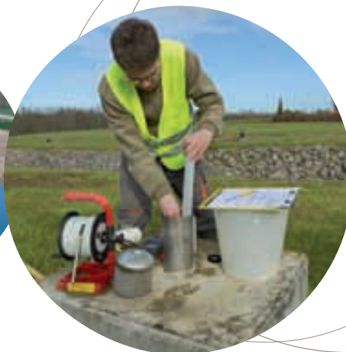
Prélèvement d'eau dans un piézomètre
