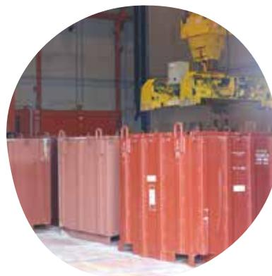
Caissons de 5m<sup>3</sup> injectés de mortier
