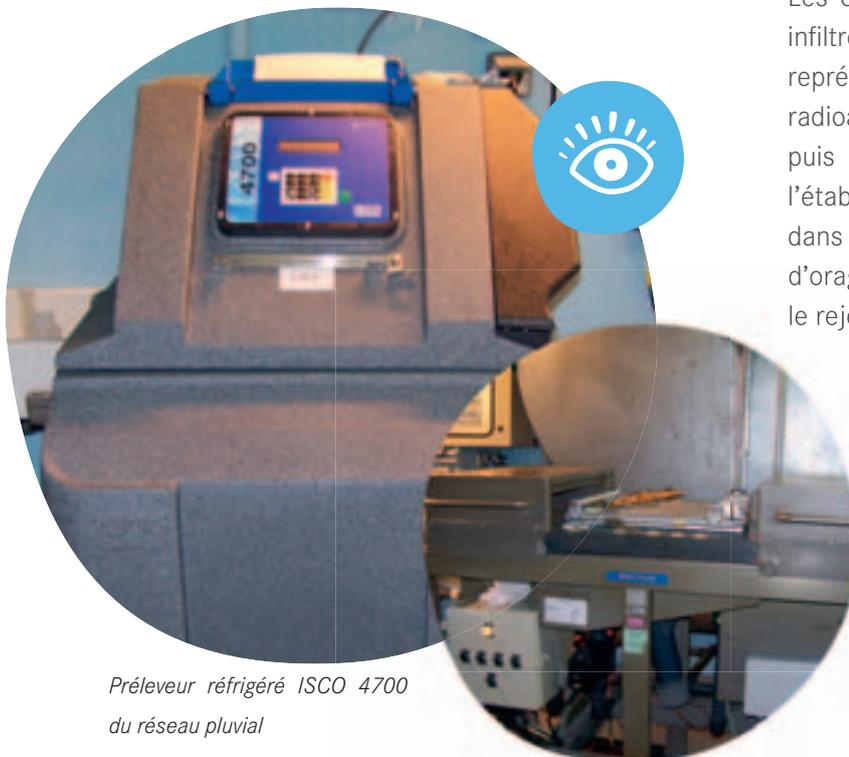
Préleveur réfrigéré ISCO 4700 du réseau pluvial
