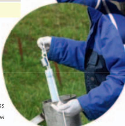
Prise d'échantillon dans le Réseau séparatif gravitaire enterré
