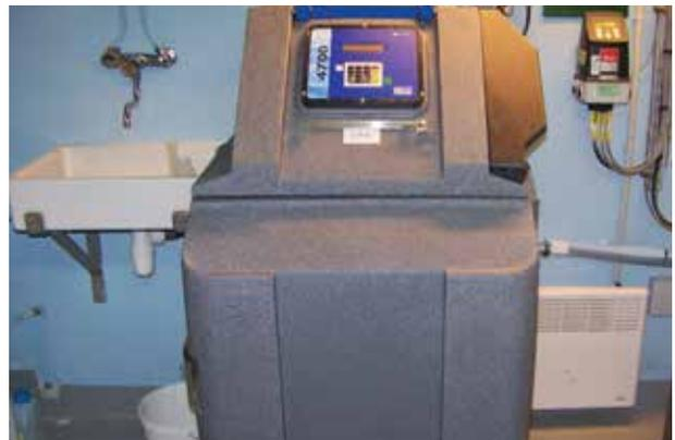
Préleveur réfrigéré ISCO 4700 du réseau pluvial
