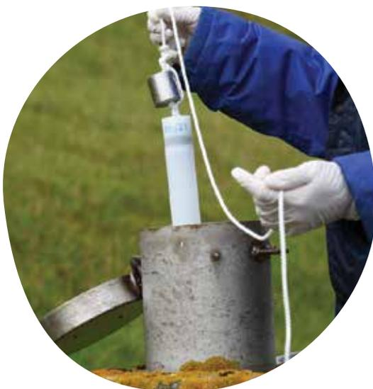
Prélèvement dans un piézomètre
