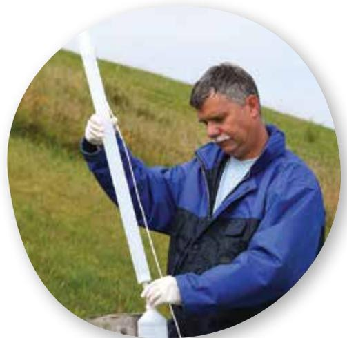
Prélèvement dans un piézomètre.
