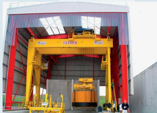
Mise en alvéole de stockage d'un couvercle de cuve d'une centrale nucléaire d'EDF.
