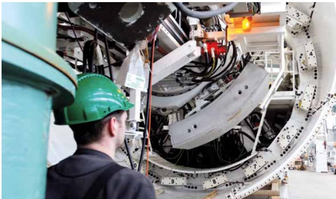
Les voussoirs en béton sont mis en place à l'arrière du tunnelier (photo prise lors des essais en surface).
