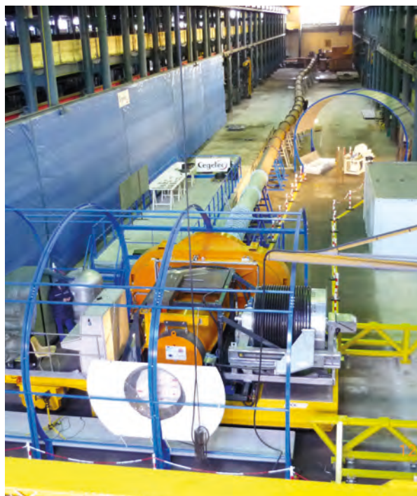
Essai de récupérabilité de colis de déchets de haute activité.
