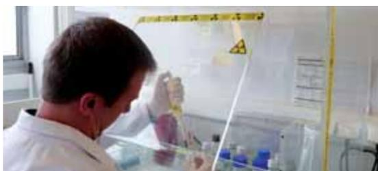
Pour arrêter totalement le rayonnement émis par le Phosphore 32, les utilisateurs travaillent derrière un écran en plexi de 1 cm d'épaisseur.
