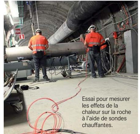
Essai pour mesurer les effets de la chaleur sur la roche à l'aide de sondes chauffantes.
