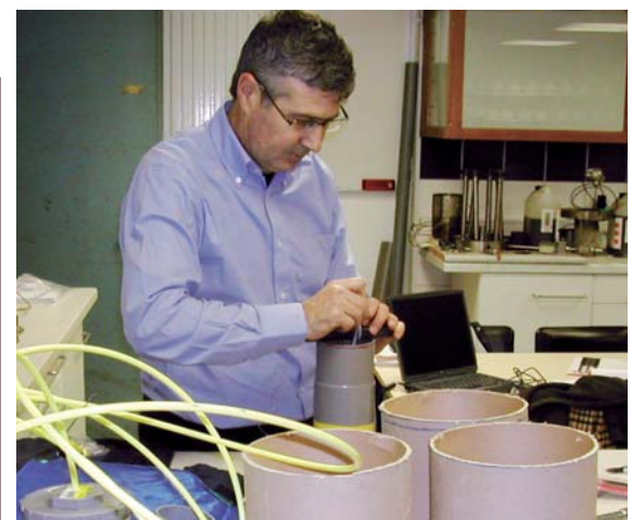
Jean-Philippe Dubois a adapté un capteur robuste et efficace pour suivre la teneur en eau dans les bétons.
