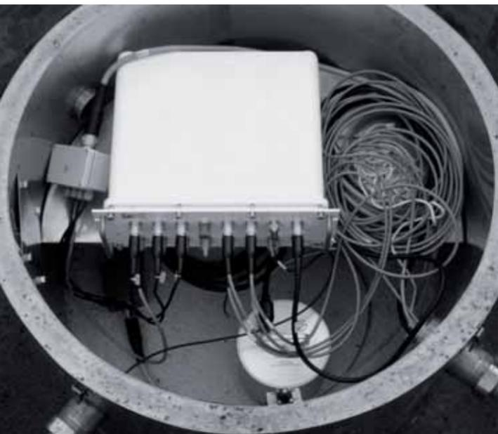
Accéléromètre 3 axes utilisé pour surveiller les séismes.
