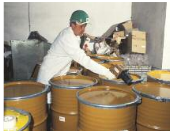
Usine d'Orflam Plast - Contrôle radiologique de fûts.
