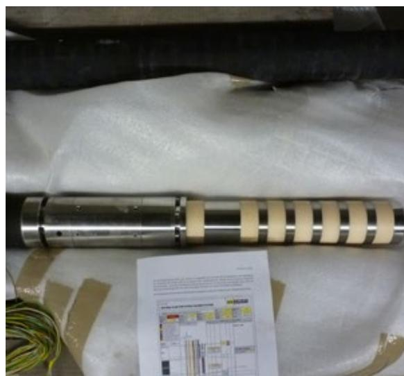
Cellule électrochimique pour mesure de vitesse de corrosion
