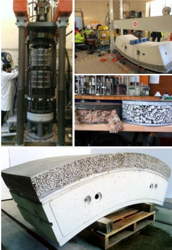
Des essais mécaniques (essais œdométriques et triaxiaux à grande échelle) et hydromécaniques ont été menés en laboratoire jour, pour quantifier la capacité de compressibilité de la couche d'argilites cuites et définir son modèle de comportement mécanique pour les calculs de dimensionnement.
