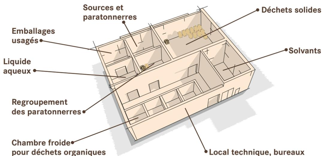
D'une surface de 2000 m<sup>2</sup>, le **bâtiment d'entreposage** est divisé en trois espaces adaptés aux catégories de déchets entreposés, selon le débit de dose au contact des colis. Il est constitué de murs en bardages métalliques ou en béton dont l'épaisseur peut aller jusqu'à 40 cm (selon les locaux). Il est de plus entouré d'une enceinte de terre d'une dizaine de mètres destinée à fournir une protection supplémentaire contre l'irradiation.
