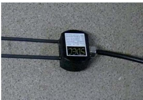
Ce capteur permet de mesurer la teneur en eau de l'argile.
