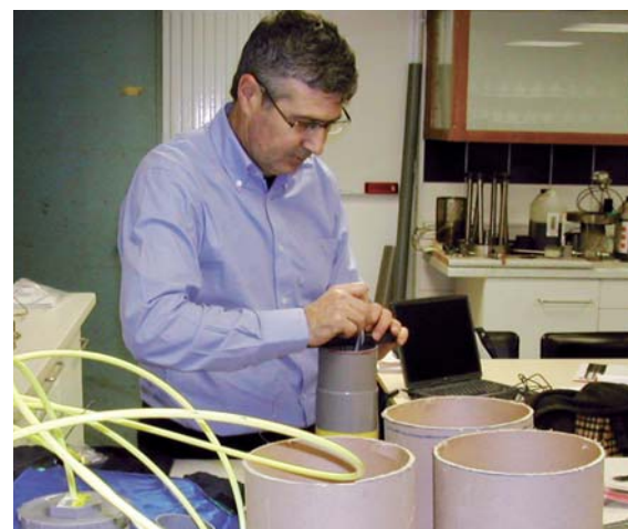
Jean-Philippe Dubois a adapté un capteur robuste et efficace pour suivre la teneur en eau dans les bétons.
