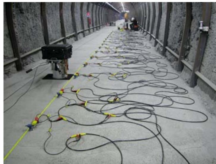
Dispositif de mesure géophysique dans le cadre d'une étude sur la détection des failles dans l'argile de Tournemire.
