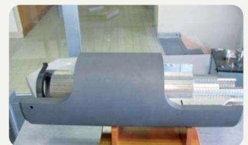
Le graphite, forme solide de carbone, était utilisé jusque dans les années quatre-vingt-dix dans les centrales nucléaires françaises de première génération. La plus grande partie de ce graphite est encore au cœur des réacteurs arrêtés en attente de démantèlement.
