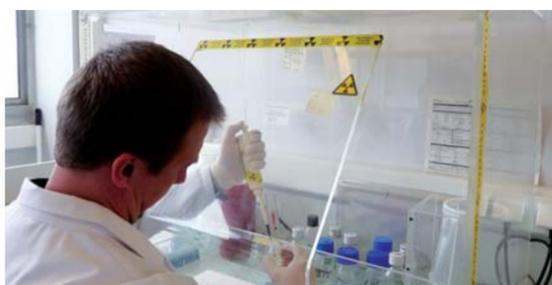
Pour arrêter totalement le rayonnement émis par le Phosphore 32, les utilisateurs travaillent derrière un écran en plexi de 1 cm d'épaisseur.
