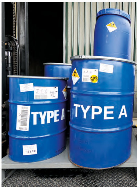
Fûts pour la collecte de déchets FMA auprès des producteurs non électronucléaires.
