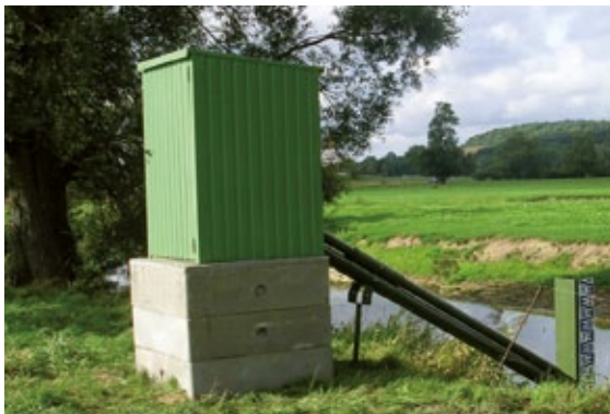
Les six stations mises en place par l'Andra disposent de sondes immergées qui effectuent toutes les quatre heures des mesures de la qualité de l'eau consultables à distance.
