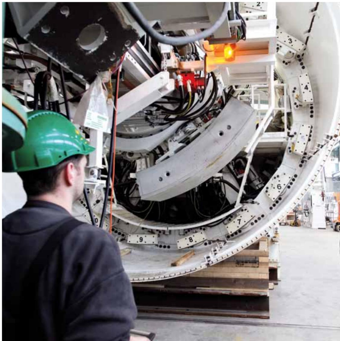
Les voussoirs en béton sont mis en place à l'arrière du tunnelier (photo prise lors des essais en surface).
