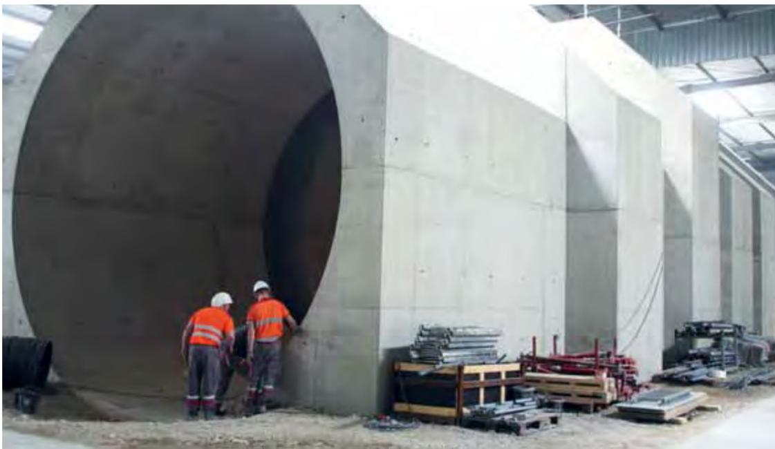
Les méthodes de fermeture du stockage Cigéo sont testées à Saint-Dizier grâce à une maquette de galerie de 35 m de long.
