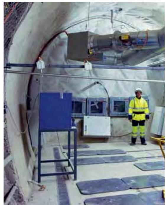
Les bactéries sont étudiées au Laboratoire souterrain dans des dispositifs spécifiques d'observation qui isolent la roche de l'air ambiant.
