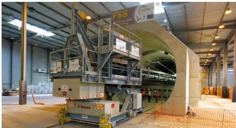
Ensileuse de bentonite testée dans une maquette de galerie de stockage.
