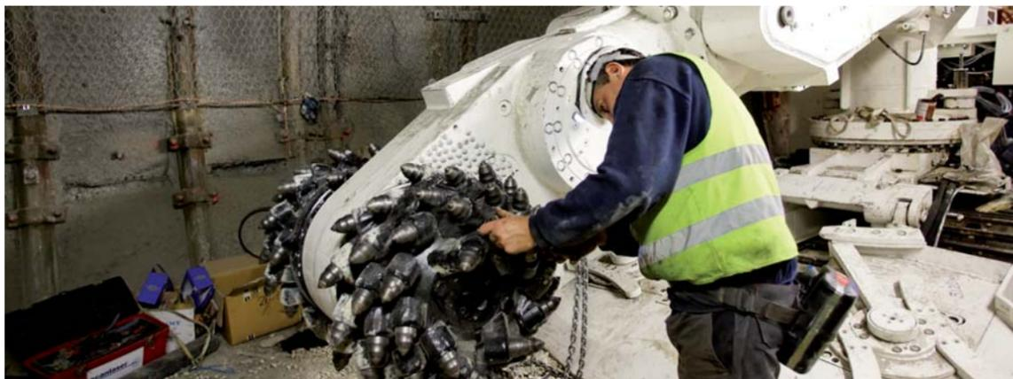
Machine à attaque ponctuelle dans les galeries du Laboratoire.
