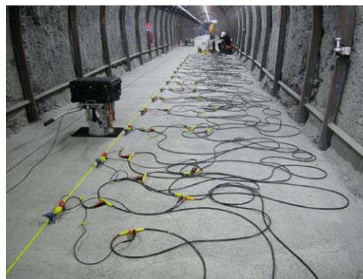
Dispositif de mesure géophysique dans le cadre d'une étude sur la détection des failles dans l'argile de Tournemire.
