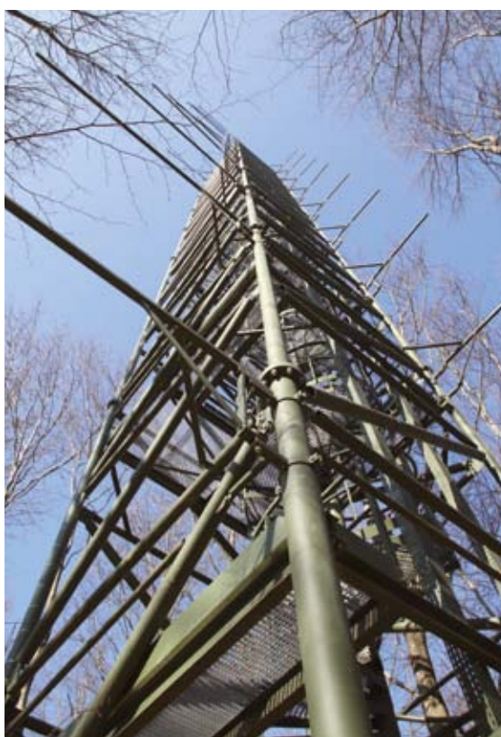
Tour à flux équipée de différents capteurs en forêt de Montiers-sur-Saulx.
